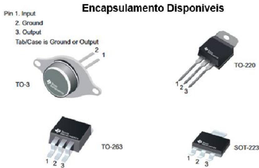
Figura 4.7 – Pinagem dos CI's da família 78XX Fonte: https://www.ti.com/lit/ds/symlink/lm7815.pdf
