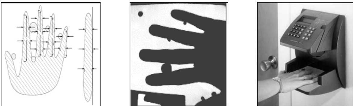
Figura 3: Funcionamento do sistema de captação de imagem e reconhecimento através da digital. (internet)
